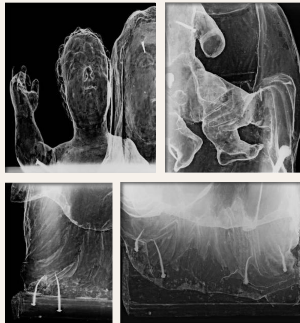
Immagini delle radiografie dalle quali si possono distinguere i metalli interni e i vari strati delle giunzioni
